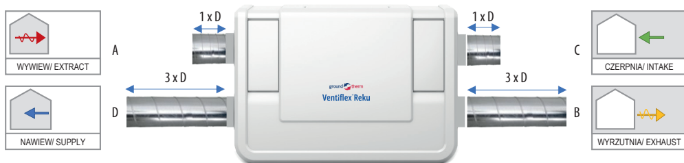
Rys. 11. Minimalne długości przewodów powietrznych
